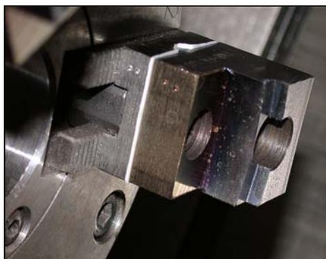
Abbildung 3.7: Getrennte Spannbacken mit Teflonfolie
