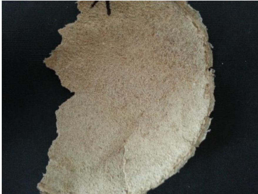
Abbildung 4-25 Exemplarisches Beispiel eines festen Rückstandes aus Biertrebern, die Probe hat eine Größe von ca. 7 auf 4 cm, Versuch S1.1
