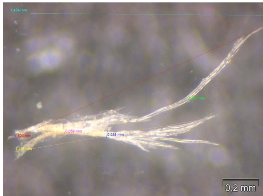
Abbildung 4-26 Exemplarisches Beispiel einer mikroskopischen Aufnahme von aufgeschlossenem Biertreber, Versuch S1.1
