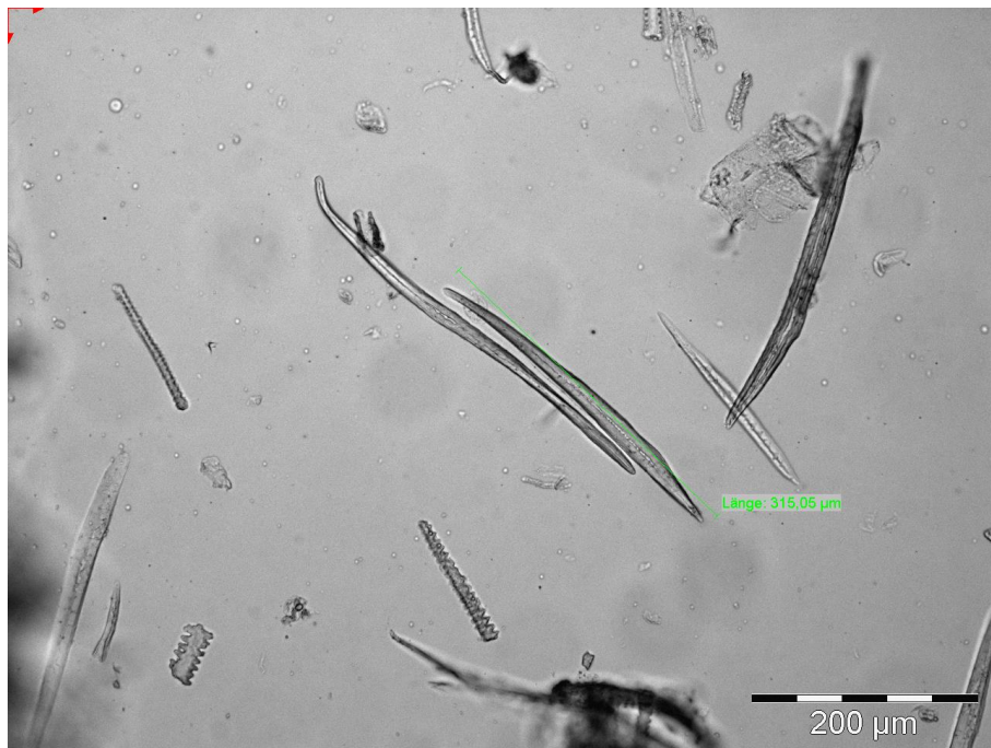
Abbildung 4-44 Exemplarisches Beispiel einer mikroskopischen Aufnahme von aufgeschlossenem Biertreber, Versuch N31.1
