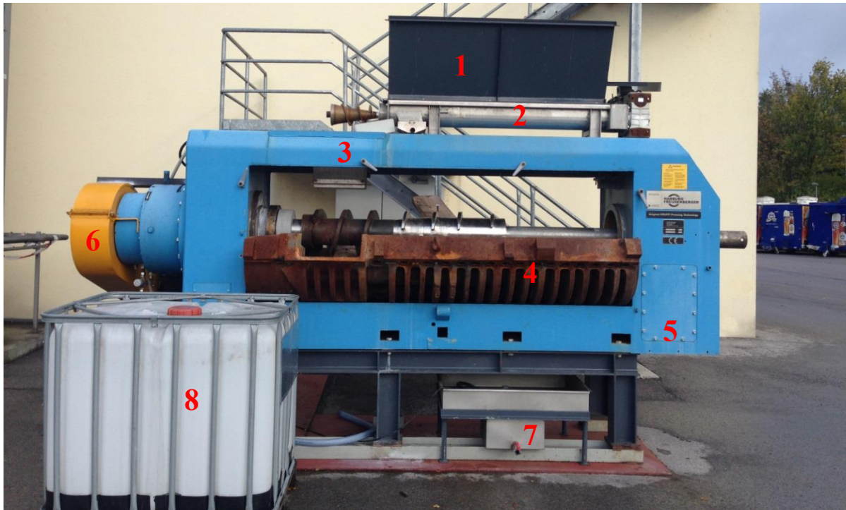
Abbildung 3-1 Versuchsanlage der Seiherschneckenpresse. Bauteile: 1. Vorratsbehälter, 2. Dosierschnecke, 3. Einlauf, 4. Presskammer, 5. Presskammer Austrag, 6. Elektromotor/Keilriemen, 7. Sammelbecken, 8. Sammelbehälter
