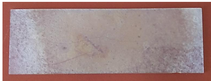
Abbildung 12: OT nach der Beschichtung. Innen ist schon die gewünschte Leitschicht entstanden und außen ist abgeschiedenes Zinn(II)-chlorid zu sehen
