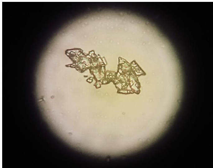
Abbildung 40: Lichtmikroskopische Aufnahme eines entstandenen PMMA-Teilchens in 400x-Vergrößerung
