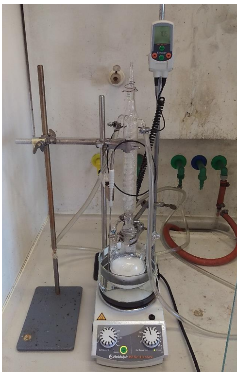
Abbildung 34: Versuchsaufbau für die Synthese von nanostrukturiertem PMMA
