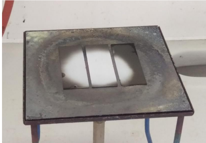
Abbildung 25: Erwärmen der Beschichtung des OTs. In der Mitte ist der Kohlenstoff bereits verglüht und außen noch nicht
