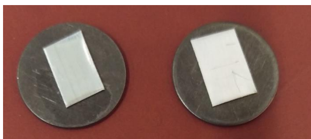
Abbildung 31: Aluminiumbleche im direkten Vergleich. Links das unbehandelte Blech und rechts das eloxierte
