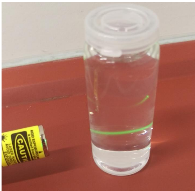
Abbildung 35: Nanostrukturiertes PMMA streut Licht in wässriger Suspension
