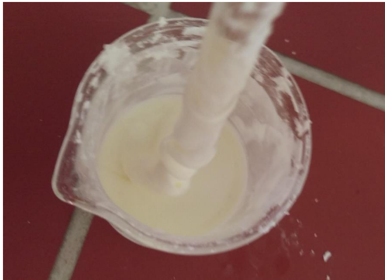
Abbildung 29: Verhalten der Mais-Wasser-Suspension bei raschem Herausziehen des Glasstabes
