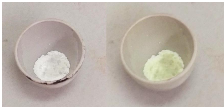
Abbildung 10: Titandioxidpulver vor (links) und direkt nach dem Erwärmen (rechts)
