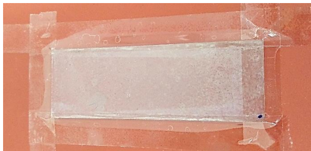
Abbildung 14: Zur Beschichtung mit Titandioxidmasse fixierter OT
