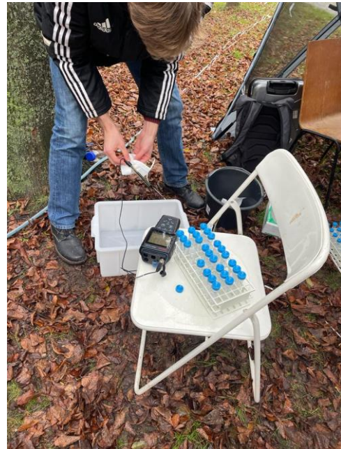
Abb. 33: Reinigung des Sensors mit destilliertem Wasser, um die Verunreinigung der nächsten Probe zu vermeiden
