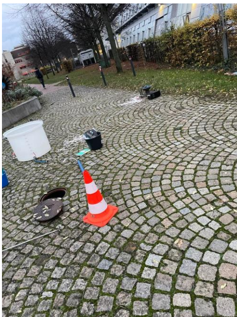
Abb. 22: Positionierung des Netzteils mit ausreichend Abstand zur Probenahmestelle, um das Eindringen von Feuchtigkeit zu verhindern
