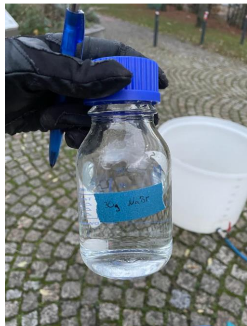
Abb. 24: In destilliertem Wasser gelöstes Natriumbromid für die Injektionslösung
