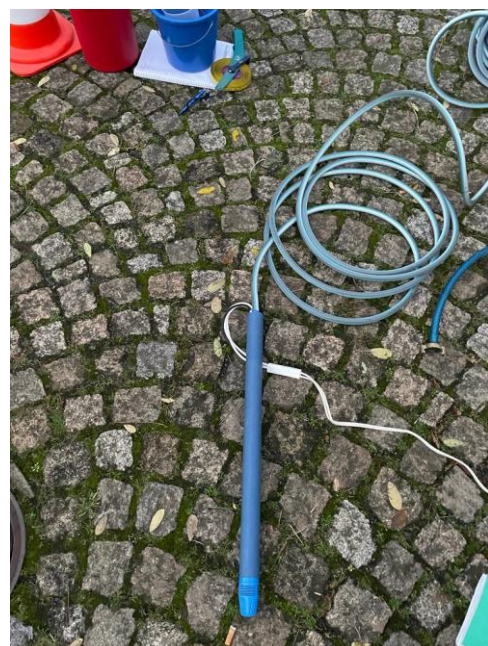
Abb. 20: Tauchpumpe für Injektion und Extraktion (Push- und Pullphase)
