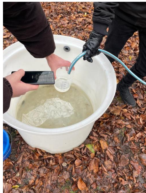
Abb. 34: Messung der Pumprate mithilfe des Durchflusses
