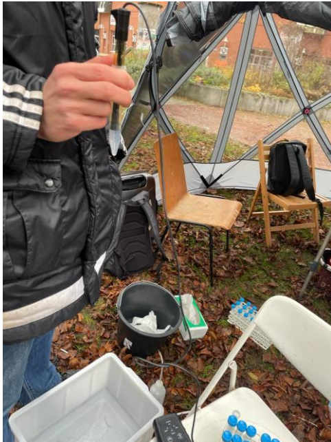
Abb. 32: Messung der ORP-Werte mit einer ionenselektiven Elektrode
