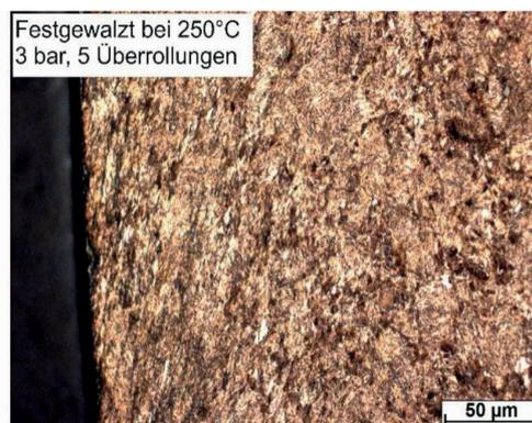
Bild 10. Kornmorphologie in der Randzone bei Festwalztemperaturen von Raumtemperatur (links) und 250 °C (rechts) bei C45E für einen Festwalzdruck von 3 bar und 5-facher Überrollung
