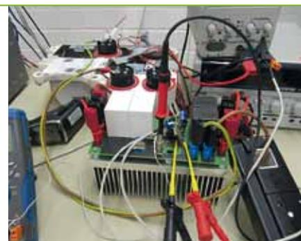
Laboraufbau eines Hochsetzstellers
