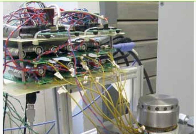
Laboraufbau des Hilfsantriebssystems
