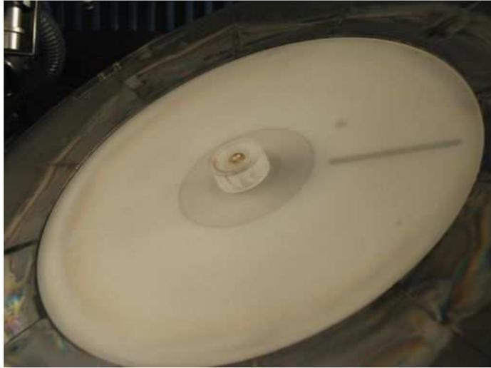
*Abbildung 3.7: Oberer Deckel (ceiling) des Planetenreaktors, in der Mitte der Gasauslaß (nozzle).*
