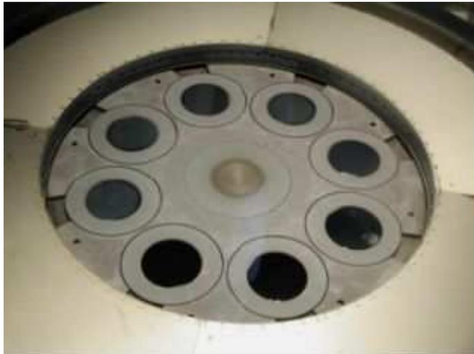
**Abbildung 3.6:** Blick in das Innere des Planetenreaktors in 8×2" Konfiguration. Die Positionen sind mit InP Substraten belegt.
