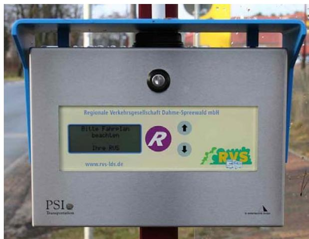
**Abb. 4.1: Bus-Ruf-Display mit automatischer Verarbeitung von eingehenden Fahrtwünschen (Quelle: PSI Transportation GmbH, Berlin)**
