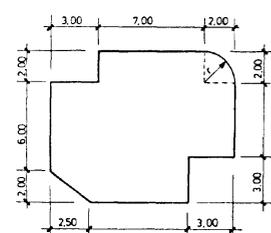
19.5. Berechnen Sie die Querschnittsfläche des abgebildeten Stahlbeton-Fertigbalkens.
