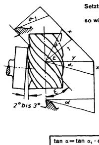
Der wirksame Freiwinkel alpha wird senkrecht zur Schneide gemessen und wird im Verhältnis zum Freiwinkel alpha um so größer, je größer der Neigungswinkel epsilon der Wendel ist.
