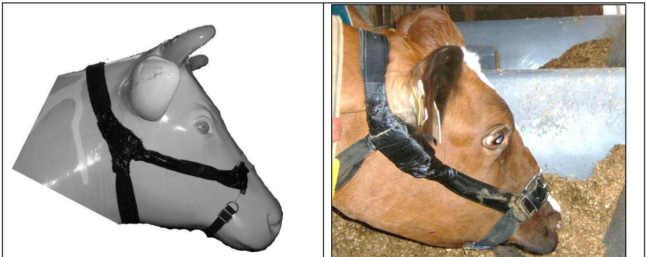
Abbildung 4-8: Kuhkopf mit Messhalfter
