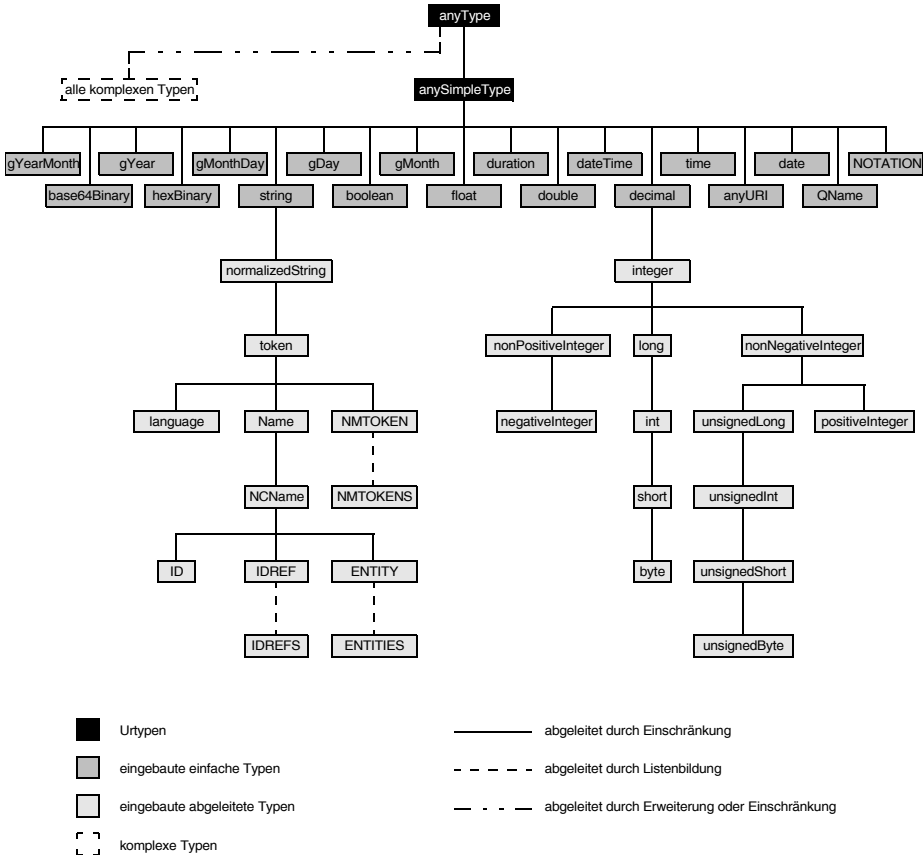
Abb. 2-1 Hierarchie der eingebauten Datentypen von XML-Schema (nach [W3C04e])
