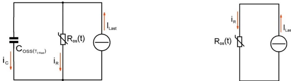
Abb. 4. 24: Ersatzschaltbilder des angesteuerten Einschaltvorgangs des unteren Transistors T_2
