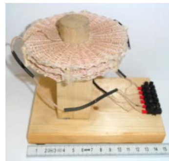
Abb. 5. 1: Wabenwickel-(Korb)spule. Links: Erstellung der zweiten Ebene auf einem Balsaholzkern. Rechts: Drei Scheibenspulen in Wabenwickeltechnik 1
