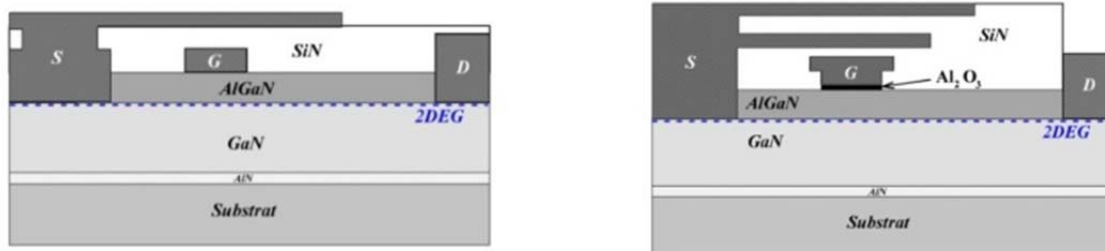
Abb. 3. 8: AlGaN/GaN-HEMT mit erweiterten Feldplattenstrukturen [117], [118]
