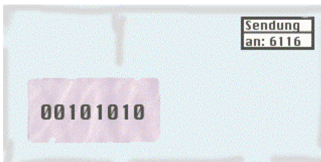
Abb. 4-6: Dualkodierte Adressierung im Speicherchip 6116
