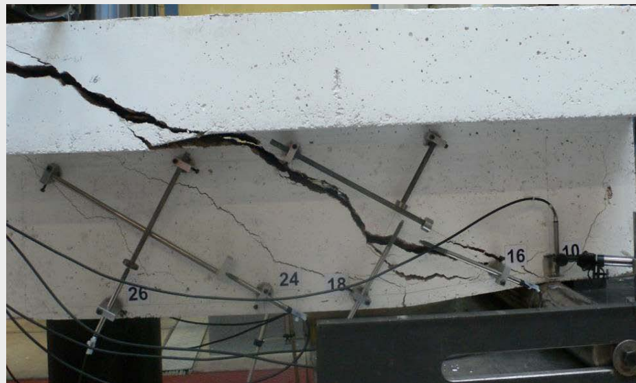
Abb. A2.95: Versagensbild am Auflager des Balkens Nr. 5
