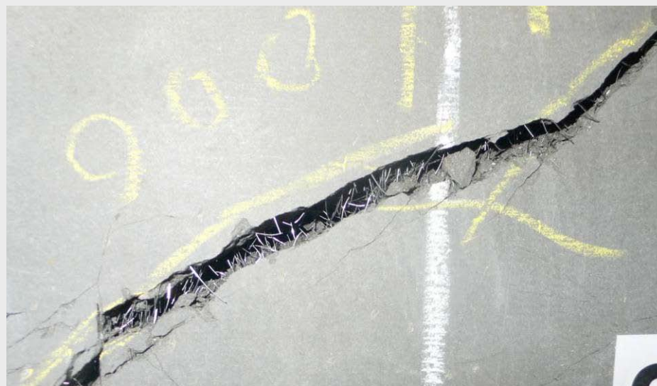
Abb. A2.124: Faserorientierung in den Rissen
