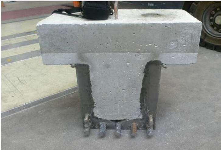
Abb. A2.15: Bildung einer Luftblase
