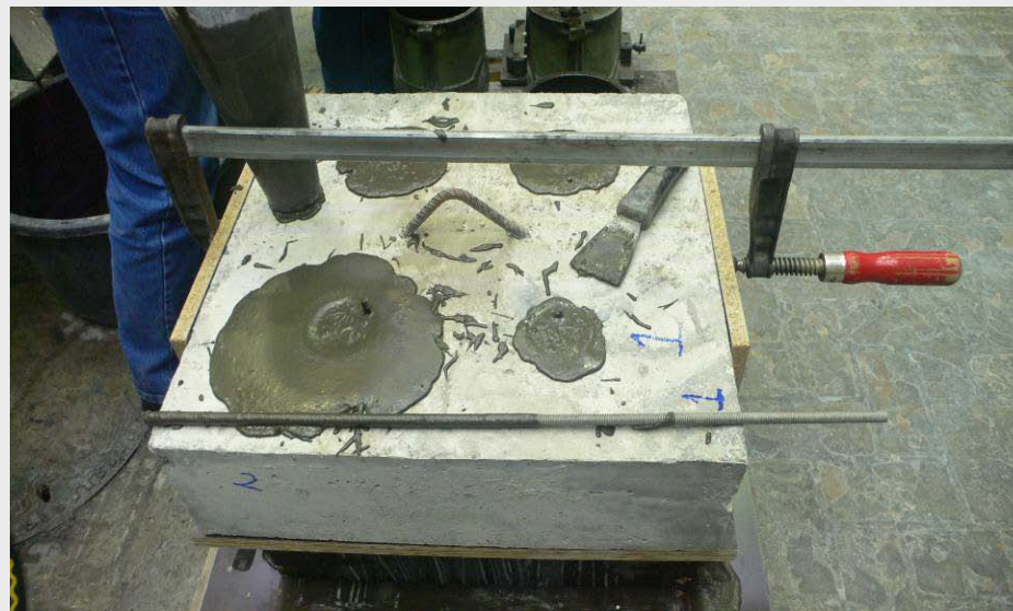
Abb. A2.19: Einfüllen des UHPCs in Löcher
