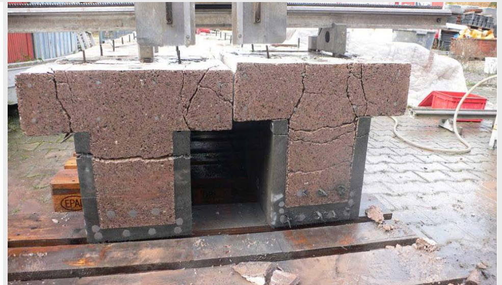
Abb. A2.135: Verformungen im Kern des Balkens
