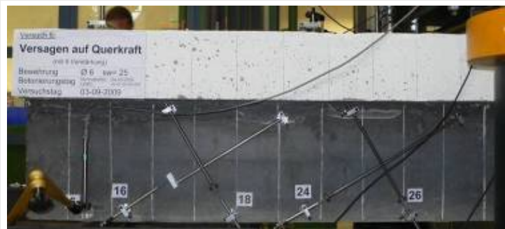
Installation der Wegaufnehmer (Teilansicht)
