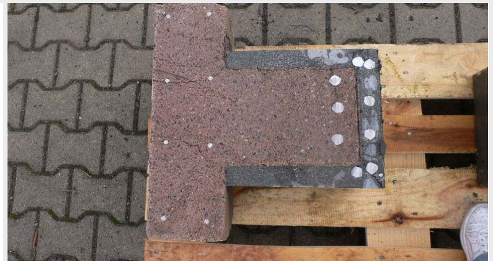
Abb. A2.135: Verformungen im Kern des Balkens
