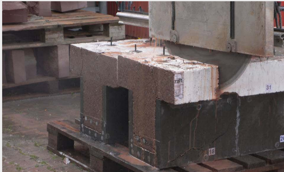
Abb. A2.134: Abschnitte im Abstand von 30 cm von der Balkenkante
