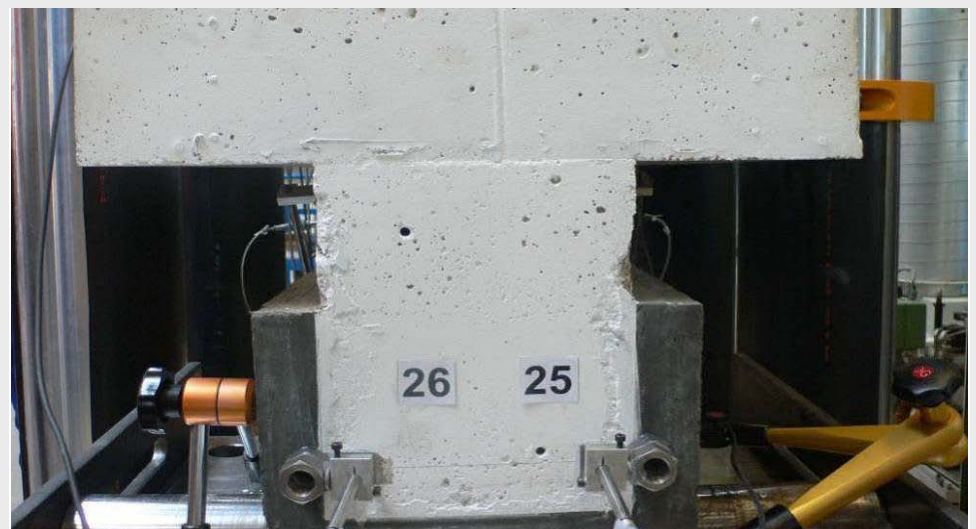
Abb. A2.62: Keine Ablösung an beiden Seiten des Balkens
