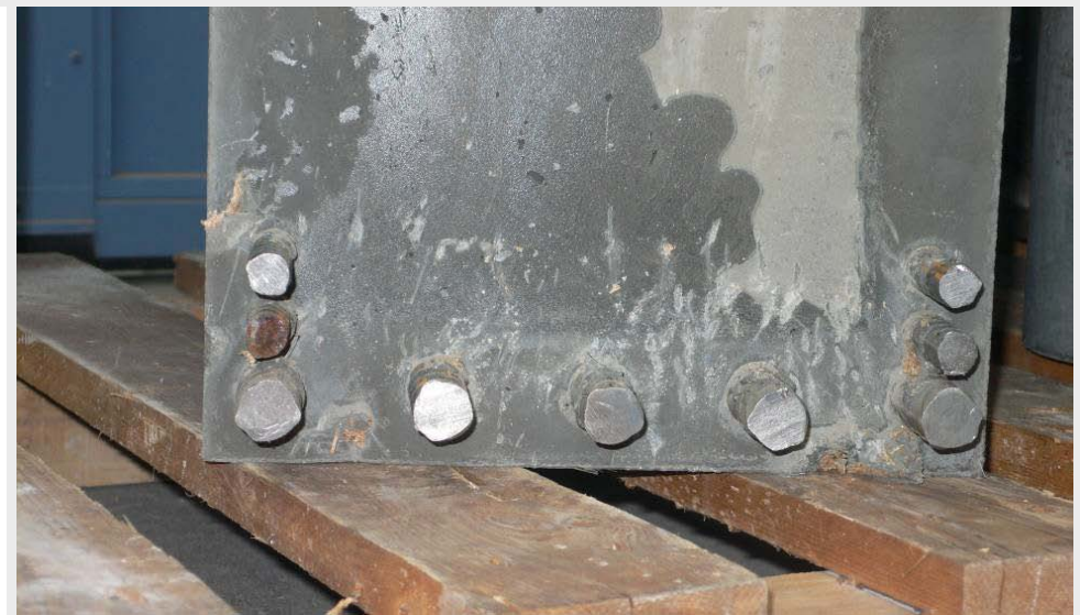
Abb. A2.20: Zweite Variante - Betonage ohne Bildung einer Luftblase
