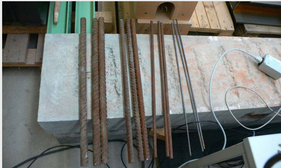
Abb. A2.30: Stabstahl-Proben
