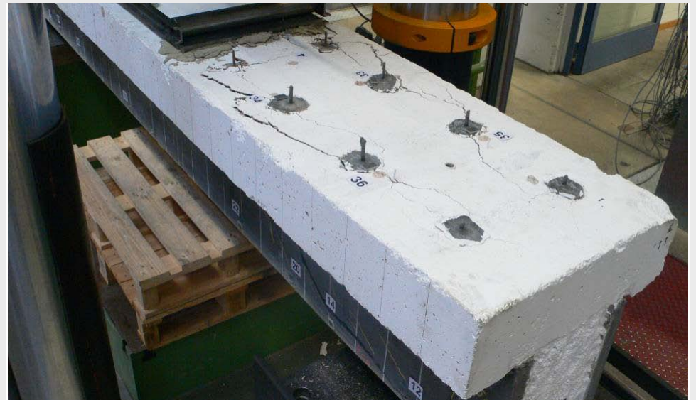
Abb. A2.107: Rissbildung im oberen Bereich des Balkens. Die Risse zeigen hier, wie der UHPC den Normalbeton geschirmt hat.
