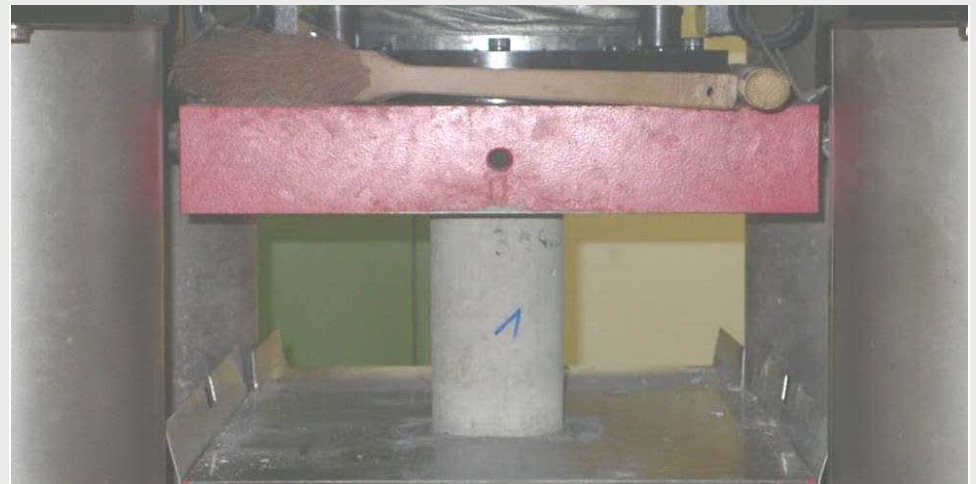
Abb. A2.25: Druckprüfung des Normalbetons
