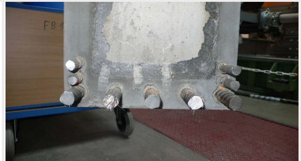
Abb. A2.20: Zweite Variante - Betonage ohne Bildung einer Luftblase
