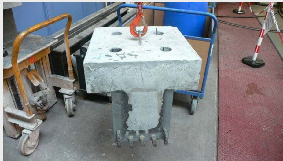
Abb. A2.21: Zweite Variante - Betonage ohne Bildung einer Luftblase
