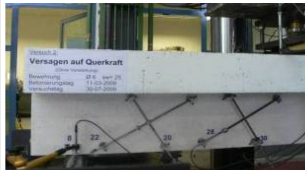
Installation der Wegaufnehmer (Teilansicht)
