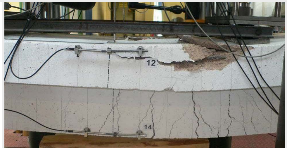
Abb. A2.71: Versagensbild des Balkens
