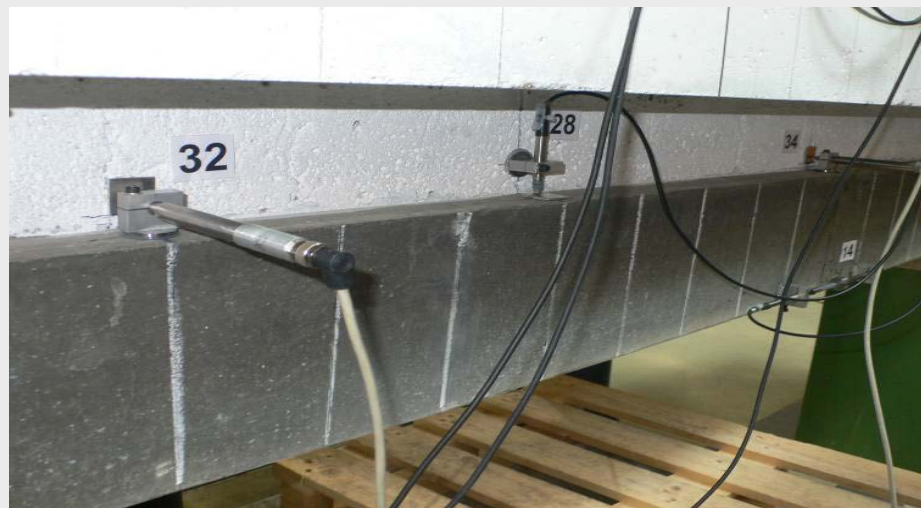
Abb. A2.58: Installation der Wegaufnehmer
