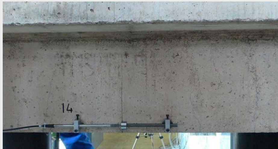
Abb. A2.51: Installation der Wegaufnehmer
