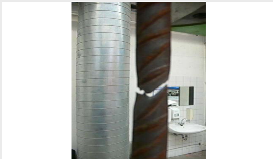
Abb. A2.31: Stabstahl nach der Zugprüfung
