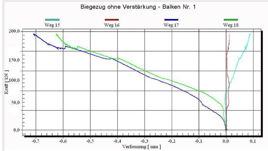
Abb. A2.56: Kraft-Scherverformungsbeziehung (diagonale Risse)
