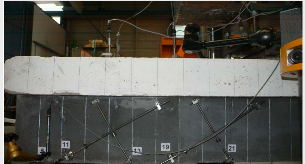
Abb. A2.103: Installation der Wegaufnehmer
