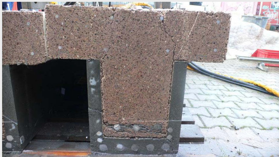
Abb. A2.136: Verformungsart im Normalbeton und UHPC
