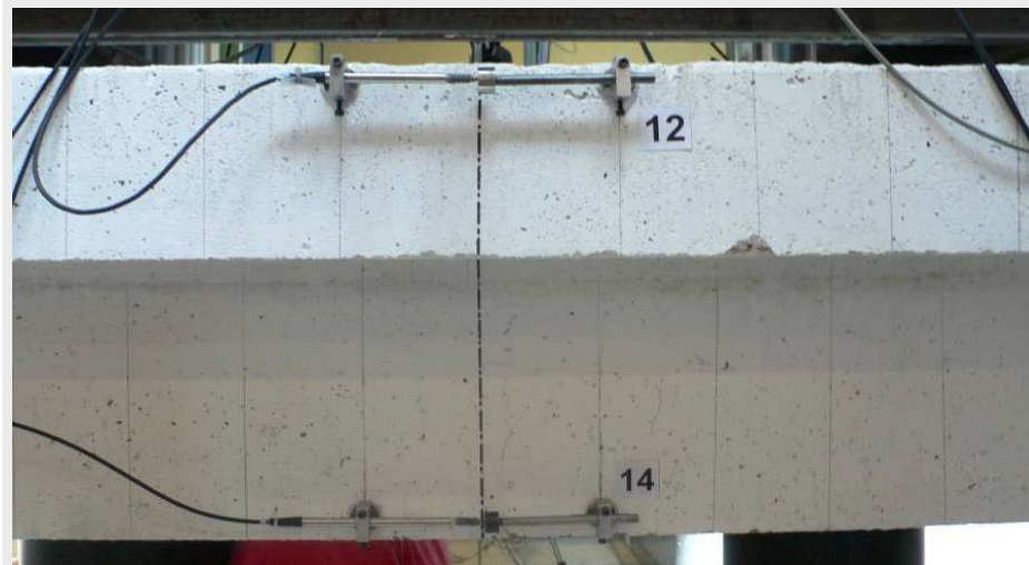
Abb. A2.70: Installation der Wegaufnehmer
