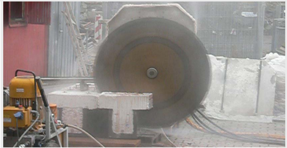
Abb. A2.132: Schnitte in den Balken Nr. 6 und 7 im Versagens-Ort, um die Verformungen im inneren Bereich zu sehen.
