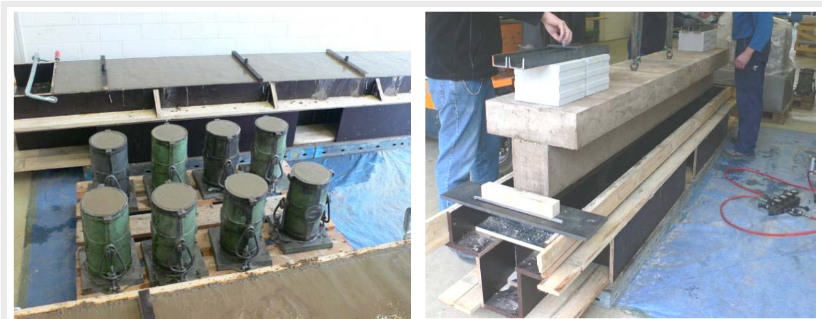
Herstellung der Balken und der Zylinderproben im Labor des Fachgebiets für Massivbau der Uni. Kassel
