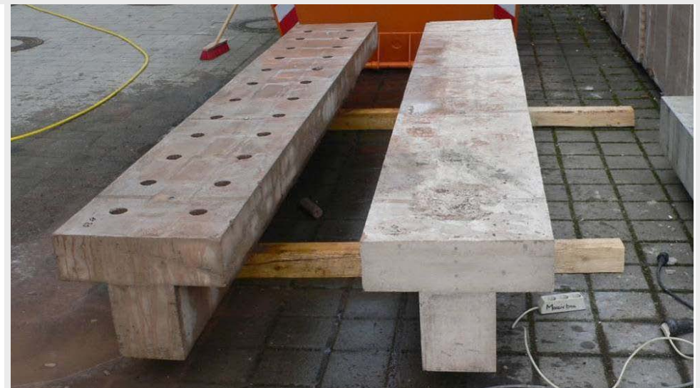
Abb. A2.39: Ausführung von Löchern in den Balken Nr. 6 und 7 um den UHPC einzufüllen und zur Herstellung eines kraftschlüssigen Anschlusses
