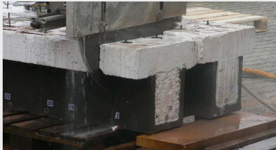
Abb. A2.133: Schnitte im Abstand von 30 cm von der Balkenkante
