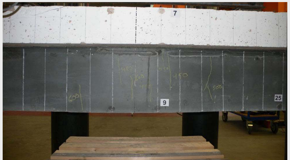
Abb. A2.109: Keine Rissbildung in der Balkenmitte
