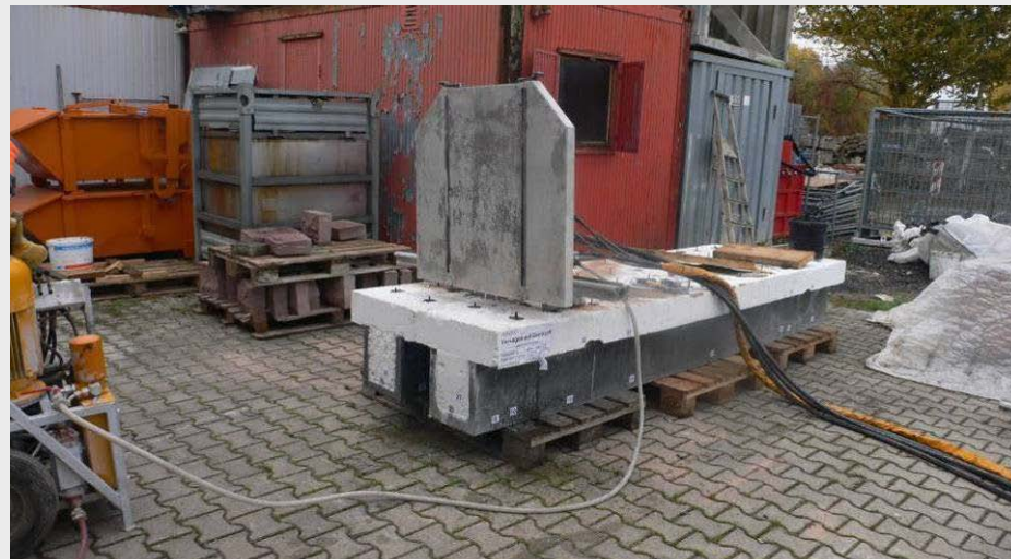
Abb. A2.132: Schnitte in den Balken Nr. 6 und 7 im Versagens-Ort, um die Verformungen im inneren Bereich zu sehen.
