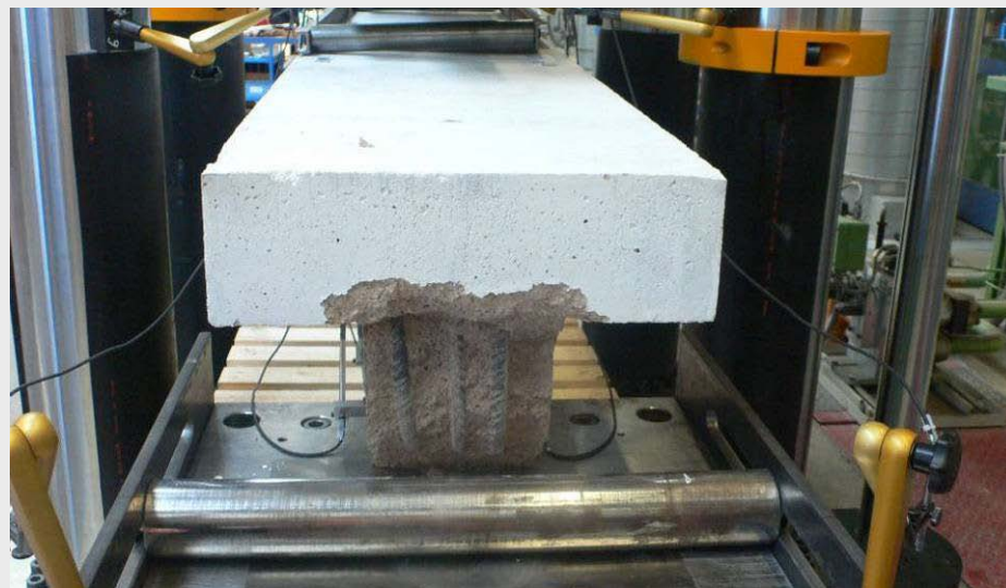
Abb. A2.73: Änderung der Lagerung während der Versuchsdurchführung
