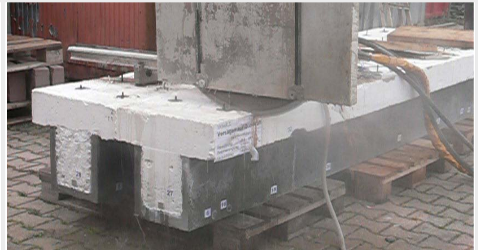
Abb. A2.132: Schnitte in den Balken Nr. 6 und 7 im Versagens-Ort, um die Verformungen im inneren Bereich zu sehen.
