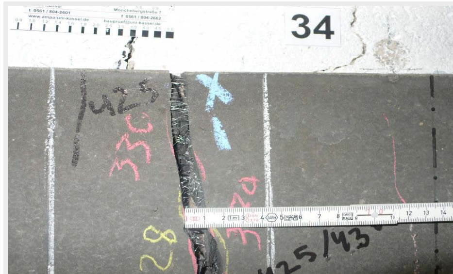
Abb. A2.63: Messung der Rissaufweitung
