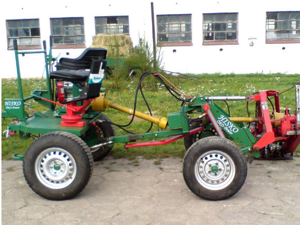
Abbildung A-8: Vorderwagen „HISKO“ mit angehängtem Doppelmesser-Mähwerk; (Hersteller: Kurt Ohrndorf, D)
