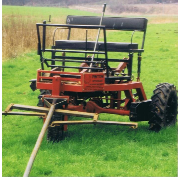
Abbildung A-5: Vorderwagen „Pintow Big Team“ (Hersteller: Carthorse Machinery, GB)
