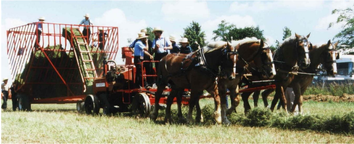
Abbildung A-9: Vorderwagen mit angehängter Mittelkanal-Hochdruckpresse und Ballensammelwagen
