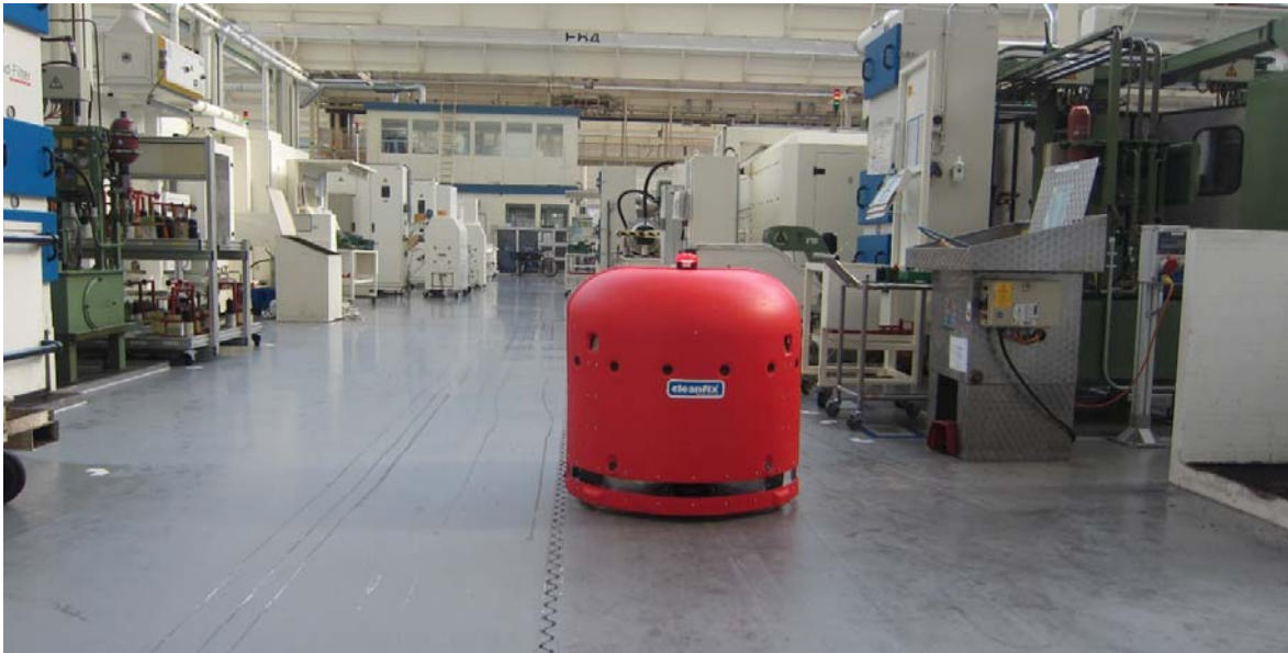
Abbildung 57: Autonom navigierender Reinigungsroboter der Fa. Cleanfix
