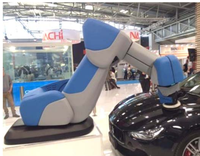
Abbildung 5: Polierroboter mit 130 kg Traglast von Fa. Comau
