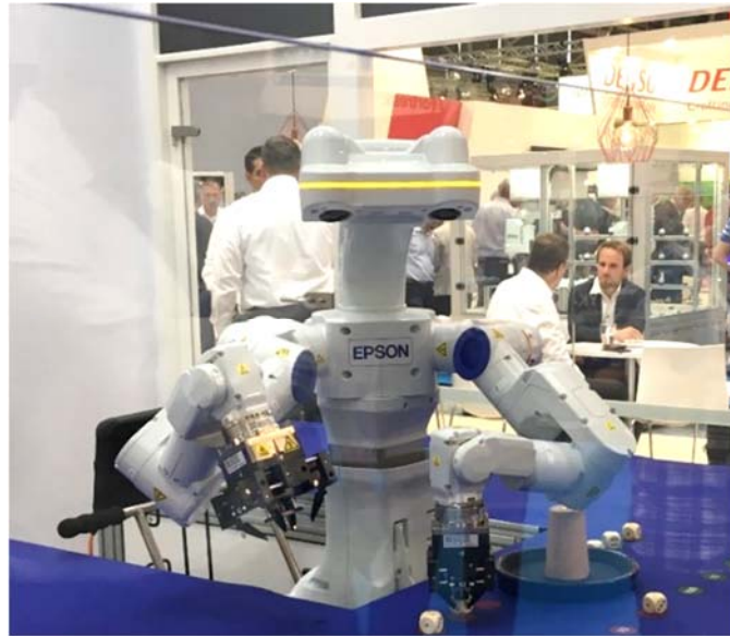
Abbildung 4: Zweiarm-Roboter der Fa. Epson
