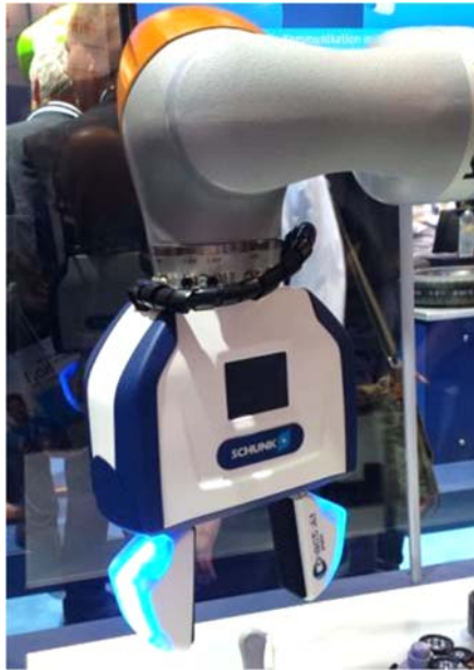
Abbildung 19: Greifer mit Bildschirm als Informationsschnittstelle (Co-act JL1 der Firma Schunk)
