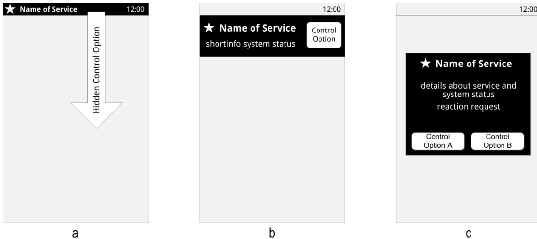
Abbildung 14: Schematische Darstellung für drei Benachrichtigungsoptionen, die unterschiedlichen Raum zur Verfügung stellen, um unterschiedliche Transparenzbedürfnisse zu berücksichtigen: Annunciator Row (a), Notification Strip (b) und Pop-Up (c).
