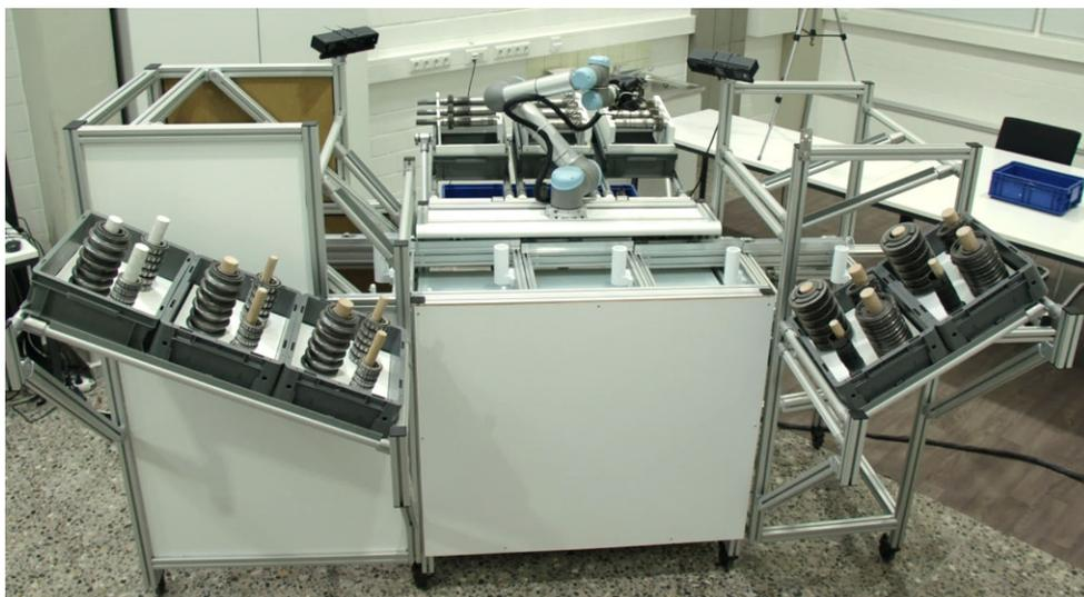
**Abb. 2** Mock-up des MRK-Arbeitsplatzes aus der Sicht des Menschen, der im mittleren abgesenkten Bereich die Montageaufgaben ausführt (links und rechts vom Montagearbeitsplatz findet sich die Materialbereitstellung, dahinter der Roboter; die Werkstückträger mit den je drei weißen Werkstückaufnahmen werden von links nach rechts gefördert)
