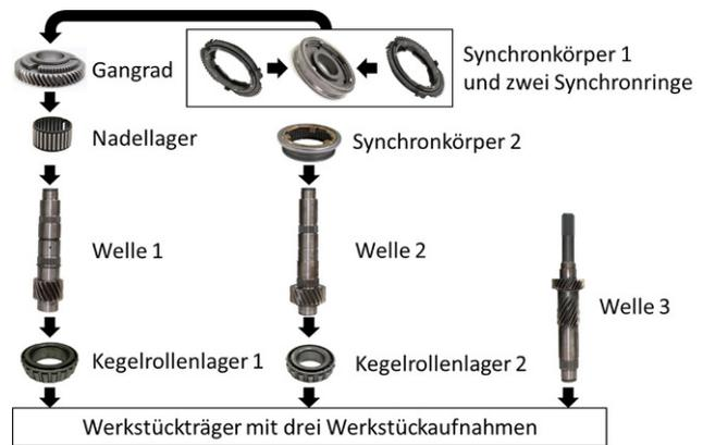
**Abb. 1** Die drei Wellen eines Wellenpakets und die jeweils zu montierenden Komponenten (*Pfeile* stellen jeweils einen Montageschritt dar)
