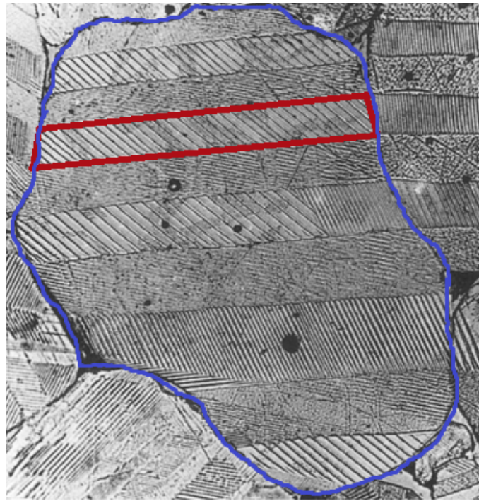
Abb. 2.5 Lichtmikroskopische Aufnahme der Domänenstruktur (rot umrandet) in einem BT-Korn (blau umrandet) (entnommen aus ARLT [6])
