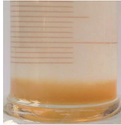
Abbildung 36: Niederschlagsartige Feststoffe in einer Ablaufprobe der Filteranlage bei Dosierung von 2,7 mg/L Fe
