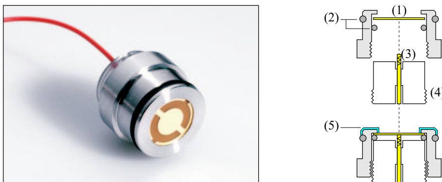
Abbildung 4.3: Aufnahme und schematische Darstellung des Schwingquarzhalters für flüssige Medien. Dabei wird eine Seite von der Flüssigkeit abgeschirmt. Schwingquarz (1), Innen- und Außendichtungsringe (2), Federkontaktstift (3), Plexiglasverschluss mit Schraubgewinde und Kontakt zur externen Elektronik (4). Die dünne Lackschicht (5) verhindert einen Kontakt zwischen Halter und Elektrolytlösung. Das Gehäuse aus Edelstahl dient als elektrische Verbindung zur frontseitigen Elektrode des Schwingquarzes.
