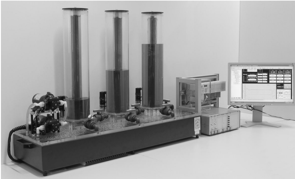
Abbildung 4.18.: Laboraufbau des Drei-Tank-Systems
