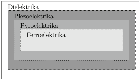
Abb. 2.2 Einordnung der Ferroelektrika in die Gruppe der Dielektrika
