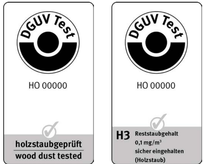
Abb. 9: DGVU Test-Plaketten „holzstaubgeprüft“ und „H3“ für Entstauber- und Absauganlagen
