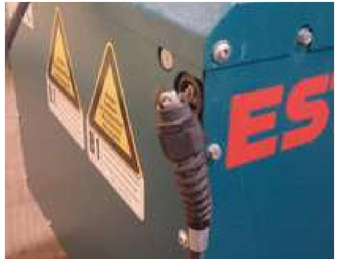
Abb. 19: Kabelzuführung an einem Schweißtrafo defekt
