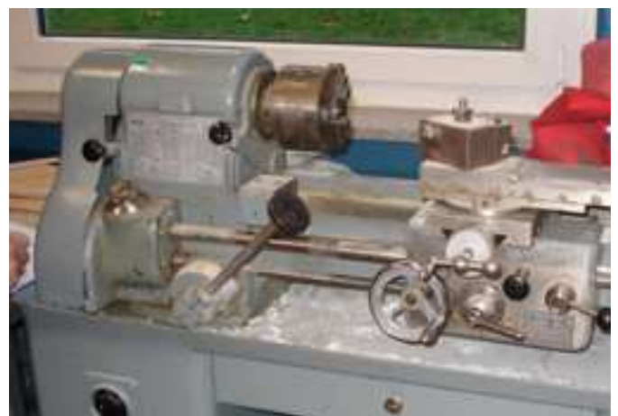
Abb. 20: Abdeckung des Drehfutters fehlt, Not-Aus-Schalter nicht vorhanden, Abdeckung der Zug- und Leitspindel fehlen
