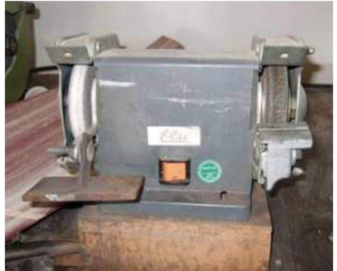
Abb. 15: Schutzabdeckungen der Schleifscheiben fehlen, Werkstückauflage defekt, Befestigung der Maschine nicht vorhanden
