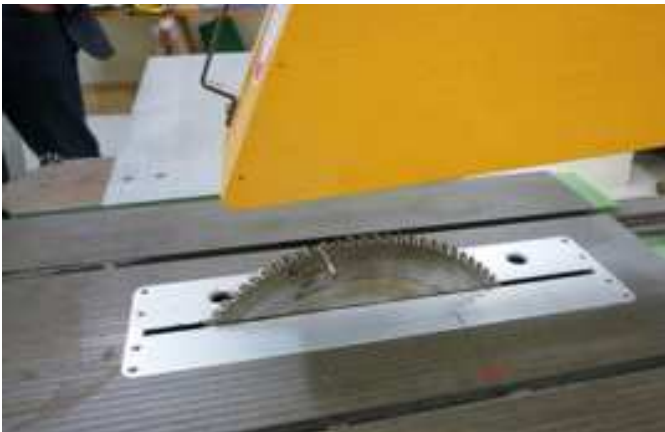
Abb. 13: Spaltkeil fehlt, Sägeblattabdeckung zu hoch bzw. senkt sich nicht selbsttätig ab
