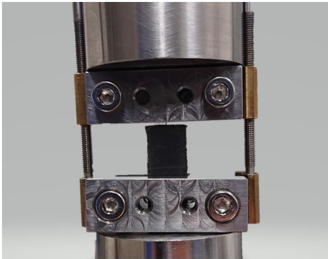
Abbildung 3 Setup für Einzelfaserauszug im Lastrahmen für Untersuchungen mittels \mu -CT
