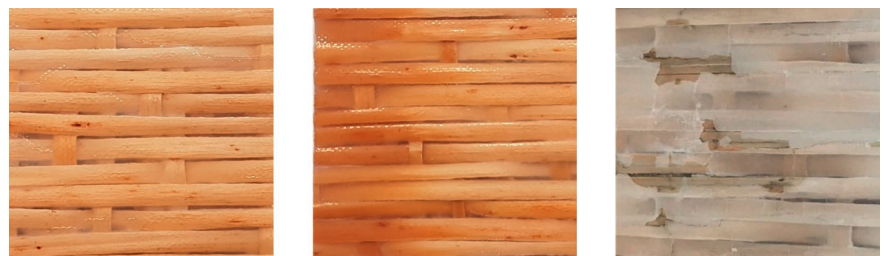
Bild 5. WTC-Prüfkörper nach Konditionierung: Im Vergleich zum Normklima-Probekörper (links) zeigt sich bei Wasserlagerung eine Verfärbung am Rand des Körpers (mitte). Durch Bewitterung (rechts) wird die Kunststoffmatrix beschädigt und vergraut. Auch die Weidenfasern weisen Farbveränderungen und Schäden auf. © ifWK
