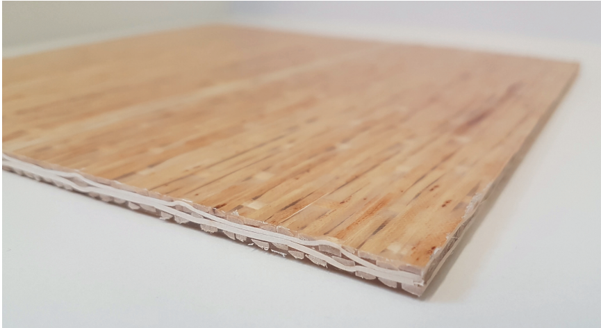
Bild 1. Für die hergestellten WTC kommt das Holz der Amerikanerweide zum Einsatz © IfWK
