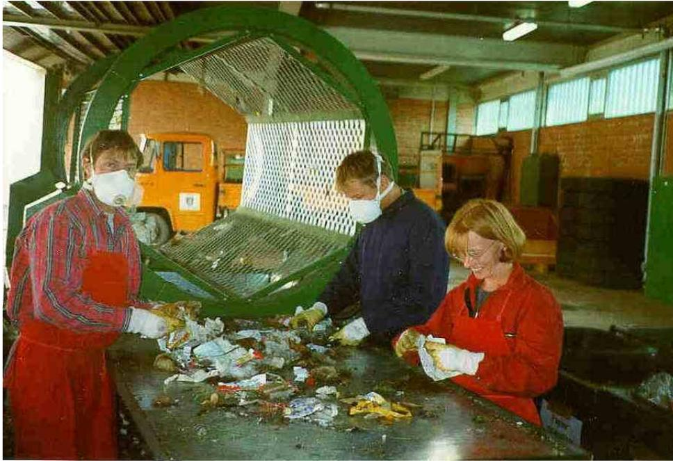
Foto 1: Hausmüllanalyse mit der Trommelsiebmaschine
