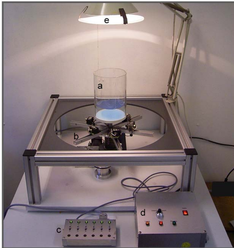
Abbildung 6: Versuchsarena mit Attrappenwechselautomatik (nach Ewert 1968 & Burghagen 1979), a: Glaszylinder mit Abdeckung, b: Attrappenarme u. -halterungen (Abdeckung fehlt), c: Schaltelement für Attrappenhalterungen, d: Steuerelement für Richtungswechsel, e: Beleuchtung, ringförmige Abgrenzung fehlt zwecks Darstellung
