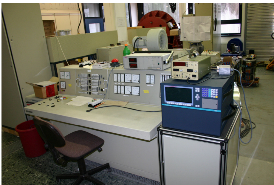
Abbildung 8.3: Power Analyser System Norma D 6000 (rechts)
