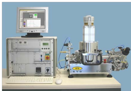
Abbildung 31: Darstellung eines EVG501-Manual-Thermo-Compression-Bonder-Systems. Dieses System wird für die Heißprägungen an der TU Braunschweig verwendet [158].
