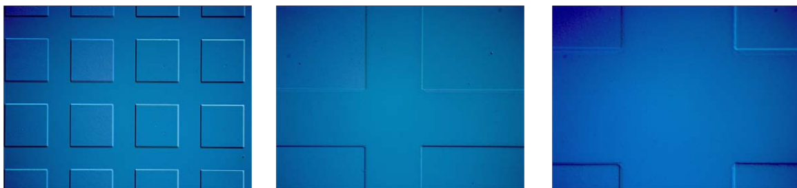
Abbildung 70: Imprintergebnisse, betrachtet in 20 und 50facher Vergrößerung durch ein Lichtmikroskop.
