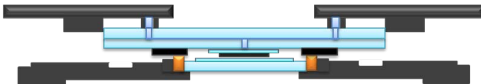
Abbildung 47: Prägeschritt 2: Schematischer Aufbau des MA4-Prägetools am INA (Vakuumkontaktmodus).
