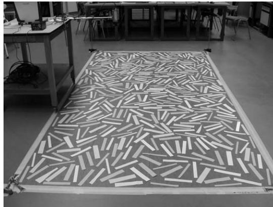
Abbildung 4-1: Labor-Testfläche mit Papierstreifenbedeckung, links ist der an einem Rolltisch montierte Kamera-Sensor zu sehen.
