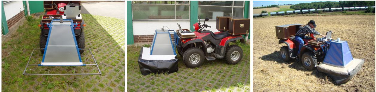
Abbildung 5-4: Versuchs-Quad mit Kamerasensor und Diffusorbox
