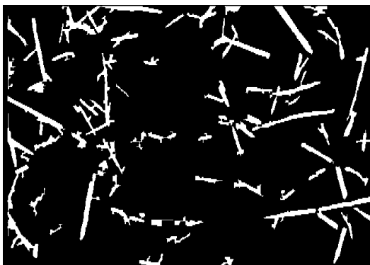
3. Vorabschätzung des Bedeckungsgrades, Ergebnis: „Niedrige“ Bedeckung
