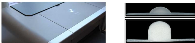
**Abb. 1.1:** Verschäumte Bauteile: links: Druckergehäuse, rechts: Schnitt durch ein nicht aufgeschäumtes Bauteil (oben) und ein aufgeschäumtes Bauteil (unten)
