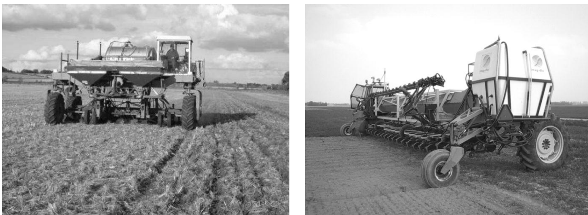
Abb. 1: Links die israelische "Field Power Unit" (FPU) mit 5.80m Arbeitsbreite, rechts ein Dowler Gantry mit 12m. Die Räder lassen sich um 90° schwenken. Im Feld wird in Quer- und auf der Strasse in Längsrichtung gefahren. Quelle: CTF Europe
