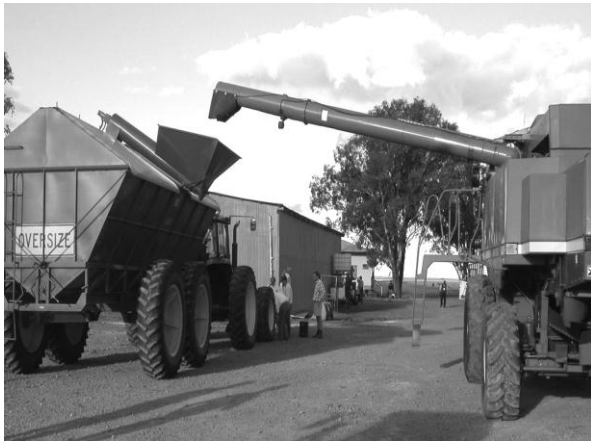
Abb. 3: Traktor und Überladewagen mit verbreiterter Spur und schmaler Bereifung, Mähdrescher mit verlängerter Überladeschnecke. Quelle: Anken
