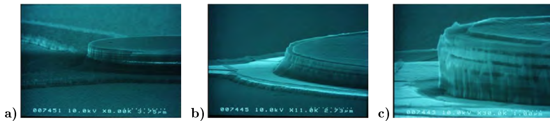
Abbildung 6.21.: REM-Aufnahmen des oberen \text{TiO}_2/\text{SiO}_2 -DBR-Spiegels nach dem ICP-RIE-Trockenätzprozess: a) zu langes Ätzen zerstört die Schichten des Membranhaltensystems (RF-Leistung liegt bei 200 W); vertikales Profil des DBR-Spiegels bei RF-Leistung von 175 W (b) und 150 W (c).
