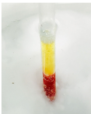
Abbildung 3.16: Auf –120 °C gekühlte Lösung der Dilithio-Verbindung \text{Fc}(\text{NLiNp})_2 ( 2 ; rot), welche mit einer Lösung von ROESKYs Dichlorsilylen-NHC-Addukt [20a,20b] überschichtet wurde (gelb); Lösungsmittel = THF- d_8 .
