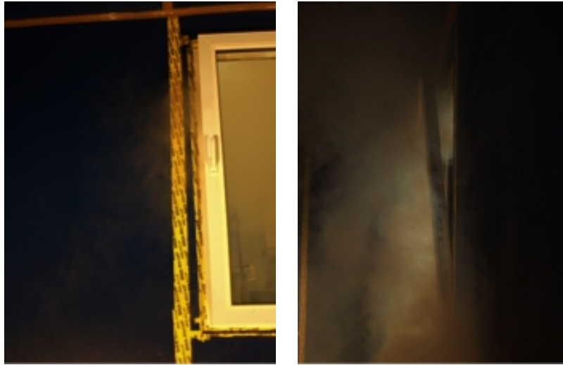
Bild 3: Visualisierung der ein- und ausströmenden Luft an einem Kippfenster.
